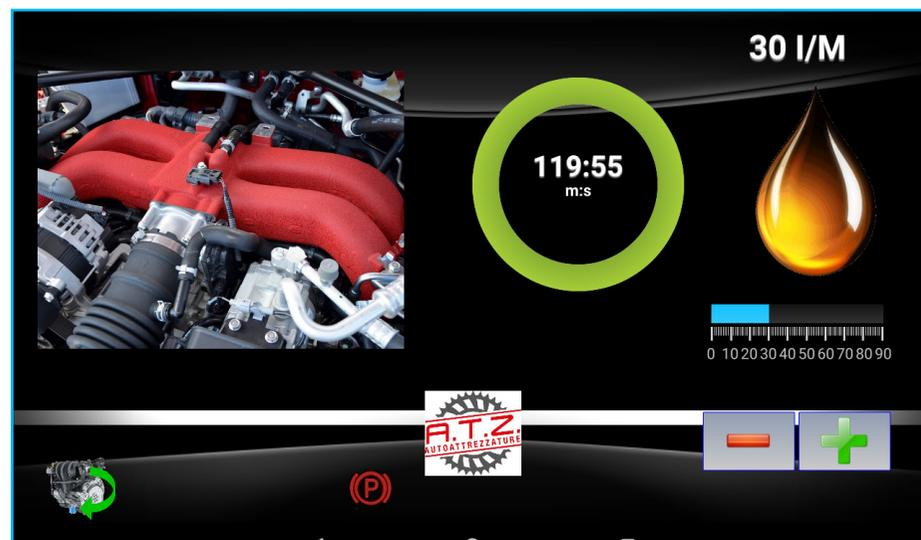
Con motore caldo e tenuto accelerato a 2000 giri circa, attraverso Cleaning Collectors nel condotto di aspirazione, per motori benzina e diesel e per motori turbo diesel subito dopo l'intercooler. E' importante che non si creino pozze di prodotto all'interno del circuito di aspirazione.
