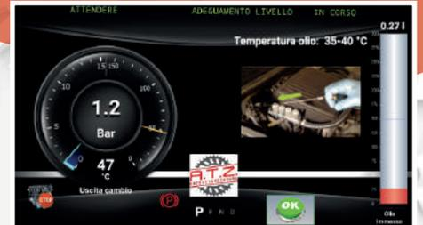
Grazie al database on line e al software di diagnosi l'operatore è facilmente istruito su tutte le operazioni (identificazione del veicolo, giusto accoppiamento, procedure, controlli) e può regolare i principali parametri del cambio.
